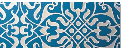
Beispiele für Kombinationstechniken: Elektrolytisch blau gefärbt und anschließend geätzt (oben), geätzt, vertiefte Flächen rot lackiert (unten).
