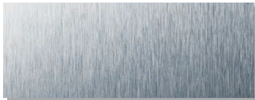
2K Diese glatte, reflektierende Ausführung ist für architektonische Anwendungen besonders geeignet, insbesondere im Außenbereich, wo schmutzabweisende Oberflächen gewünscht werden. Hierfür werden besonders feine Schleifbänder oder Bürsten eingesetzt, so daß die Rauheit R_a maximal 0,5 \mu\text{m} beträgt.
