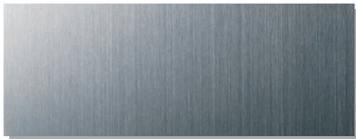
2J Diese Oberfläche wird durch Schleifbänder oder Bürsten erzielt. Der Schliff ist gerichtet, matt und wird für Innenanwendungen bevorzugt.
